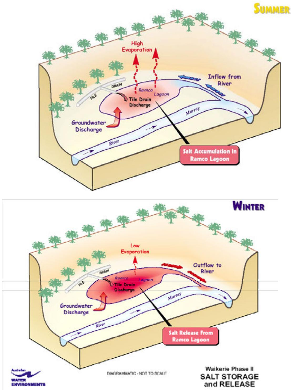
FIGURE 5.7: RAMCO LAGOON TYPICAL BACKWATER (FROM AWE 2000)
