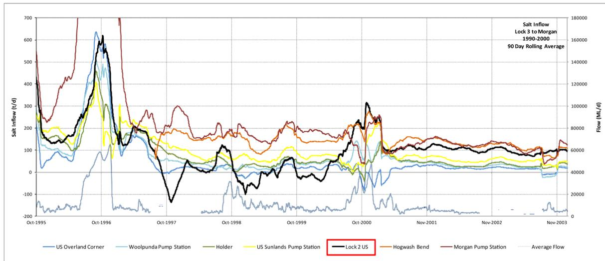
**FIGURE 6.1: SALT INFLOW BETWEEN LOCK 3 AND MORGAN ILLUSTRATING VARIABLE DATA QUALITY AT THE LOCK 2 STATION**
